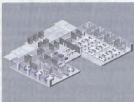
Rys. 4. Heron Tower – typowa kondygnacja z wycięciem na atrium Fig. 4. Heron Tower – typical floor with cut out for sky garden
