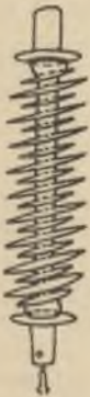
Rys. 4. Nowa konstrukcja izolatora z tworzyw sztucznych dla linii wysokiego napięcia opracowana w Wielkiej Brytanii
