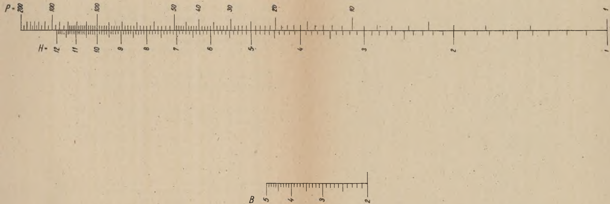
Rys.9. Nomogram logarytmiczny do obliczania powierzchni na podstawie wzoru P = H^2 / B^2
