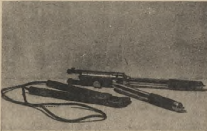
Rys. 4. Praska hydrauliczna typu PH4 oraz kleszcze zaciskowe KZ
