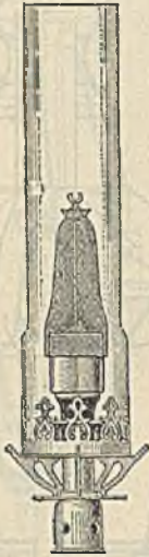
661. Газоналивная горѣлка Ауэра.
