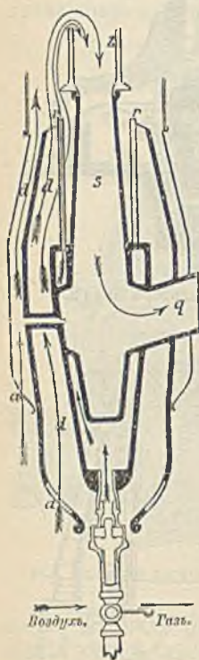
656. Регенеративная горѣлка Сименса, новая модель.
