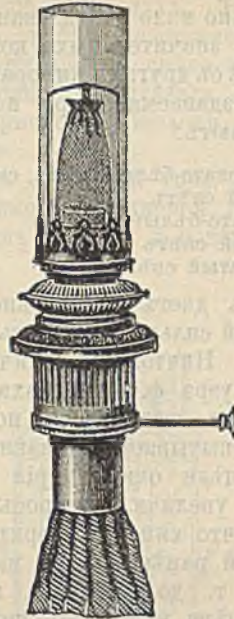
666. Спирто-калильная лампа акц. общ. бывш. Штобвассеръ въ Берлинѣ.
