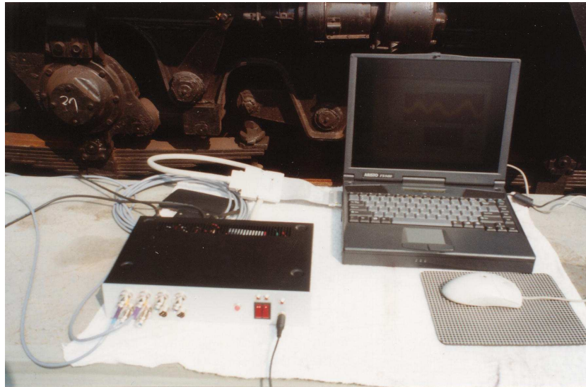
Rys. 11-1. Zestaw pomiarowy do badań dynamicznych mostów
