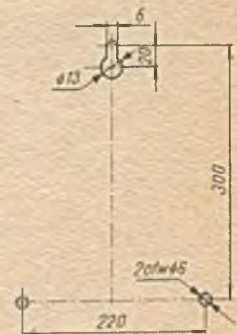
Rozmieszczenie otworów na tablicy
