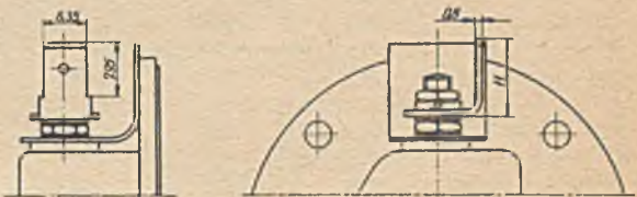
Szczegół mocowania końcówki konektorowej do czujników z oznaczeniem końcowym „S”
