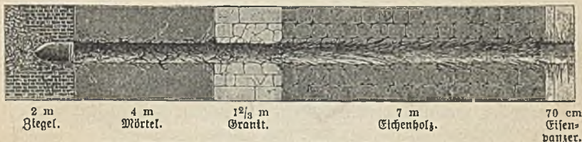
51. Schußkanal durch Panzer und Mauer. Nach „Englneering“.
