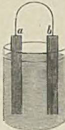
94. Galvanisches Element. a Zink; b Kupfer.
