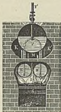
9. Durchschnitt eines Dampfessels mit zwei Siederöhren.
