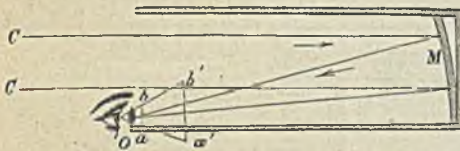
95. Die Einrichtung des Herschellschen Spiegelfernrohres.
