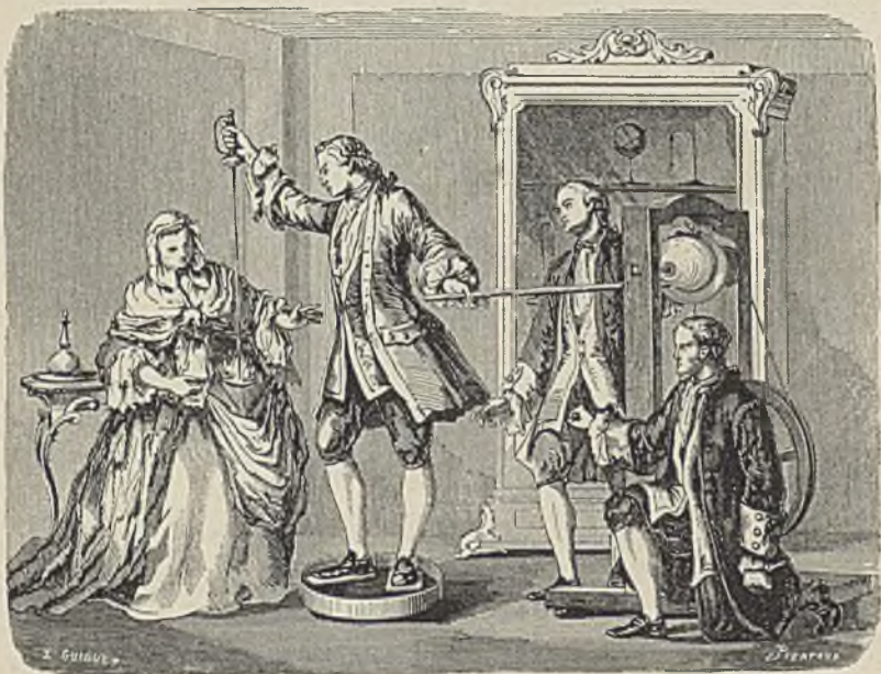
84. Entzündung von Weingeist durch den elektrischen Funken.
