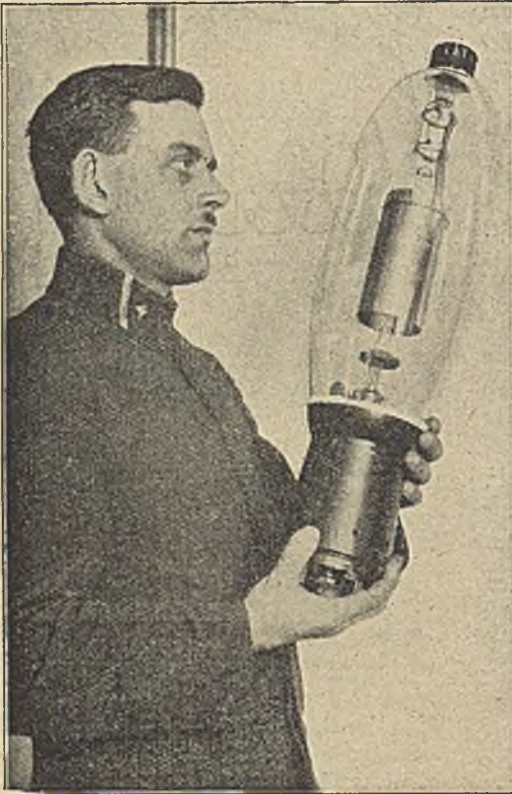
Eine der großen Senderöhren mit denen die „Deutsche Stunde“ ihre Berichte und Unterhaltungen verbreitet 4,5 Kilowatt, 16 Ampère, 1000 Volt Anodenspannung Aus der „Radio-Anschau“ (Frankfurt a. M., S. Wechholz)
