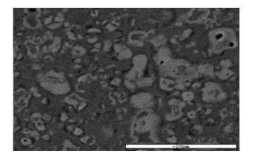
Fig. 10 Microstructue of WCTiC+VC+Co gradient material, central layer
