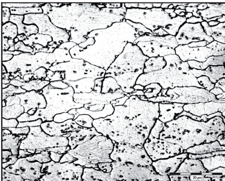
Fig. 8. Annealing mode 2, deformation 30 %
