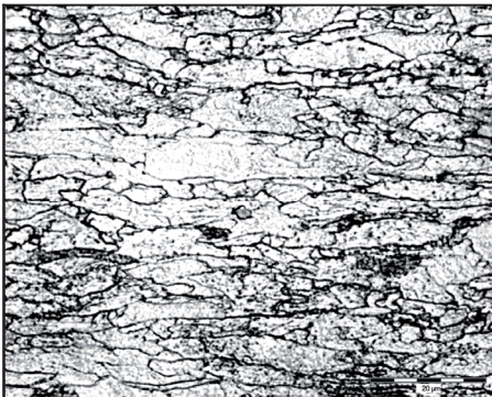
Fig. 6. Annealing mode 1, deformation 30 %
