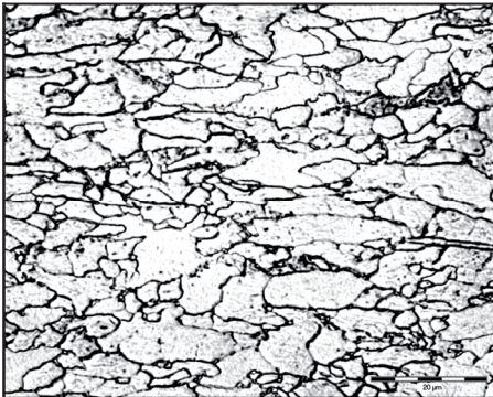
Fig. 7. Annealing mode 2, deformation 15 %
