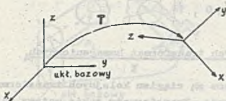
Rys. 2. Ilustracja transformaty homogenicznej Illustration of homogeneous transformation
