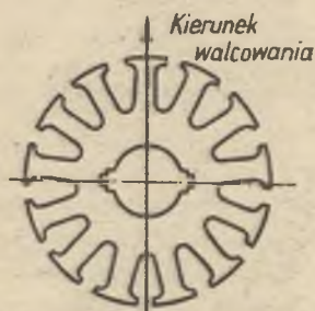
Rys. 8. Wycięcia w blasze wirnika w celu ujednoczenia permeancji rdzenia
