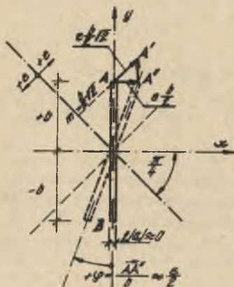
Rys. 5. Przypadek przemieszczeń fundamentu ławowego
