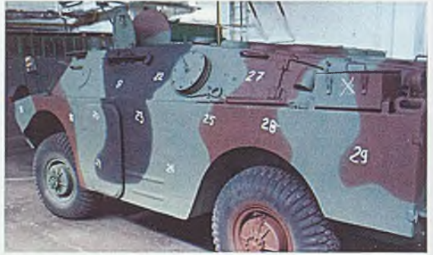
Rys. 8.30. Rozmieszczenie losowo wybranych punktów pomiarowych na panczeru wozu bojowego strona lewa
