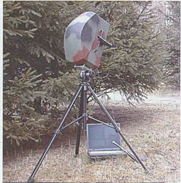
Rys. 8.8. Radar do pomiaru prędkości początkowej pocisków RUBIN-1M podłączony do komputera
