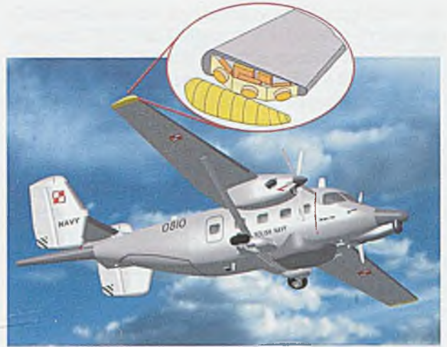
Rys. 6.7. Antena i przedwzmacniacz urządzenia LEMUR-10 umieszczone na końcach skrzydeł samolotu
