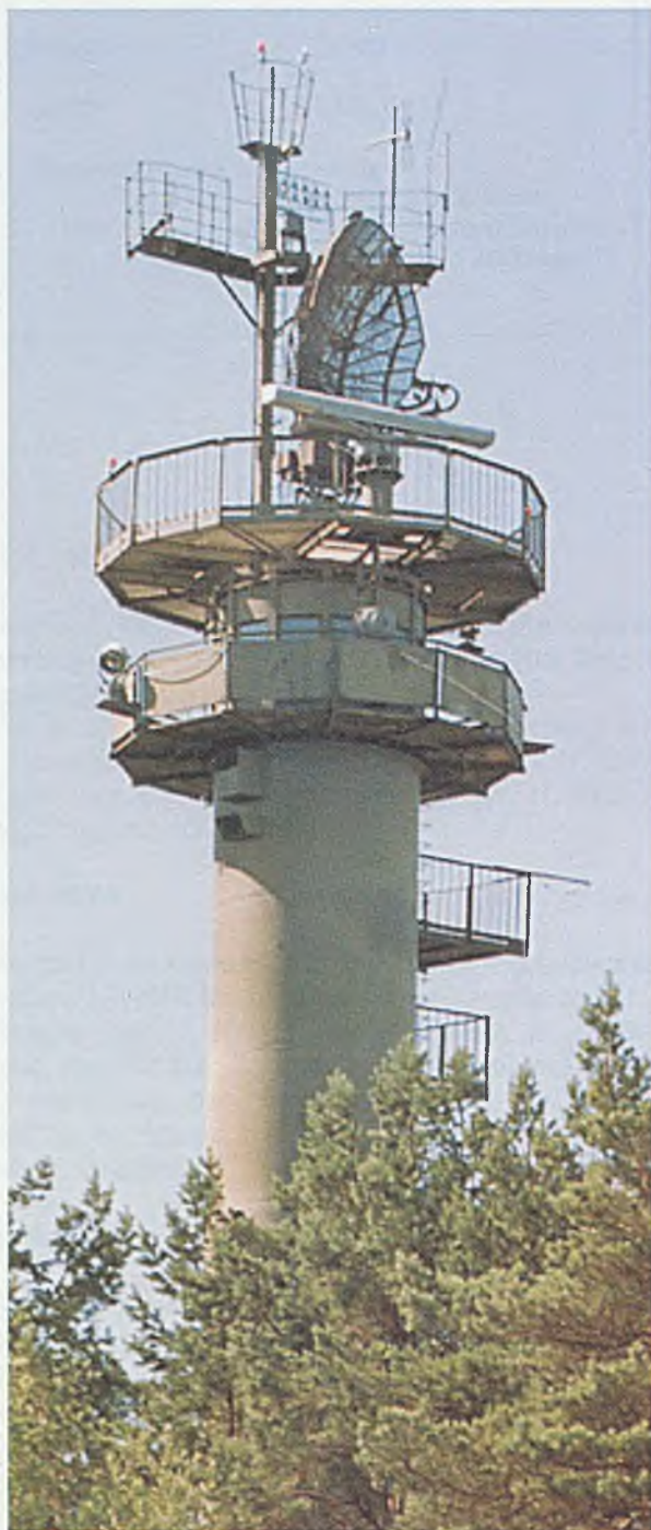
Rys. 4.1. Radar brzegowy N-23 na jednym z posterunków obserwacyjnych Marynarki Wojennej RP
