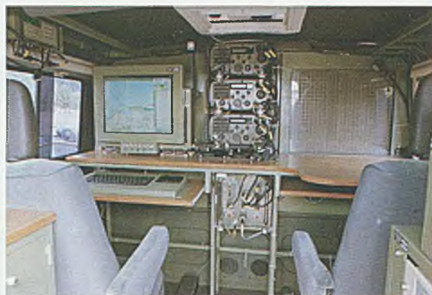
Rys. 10.15. Wnętrze kabiny operacyjnej wozu WD-2001
