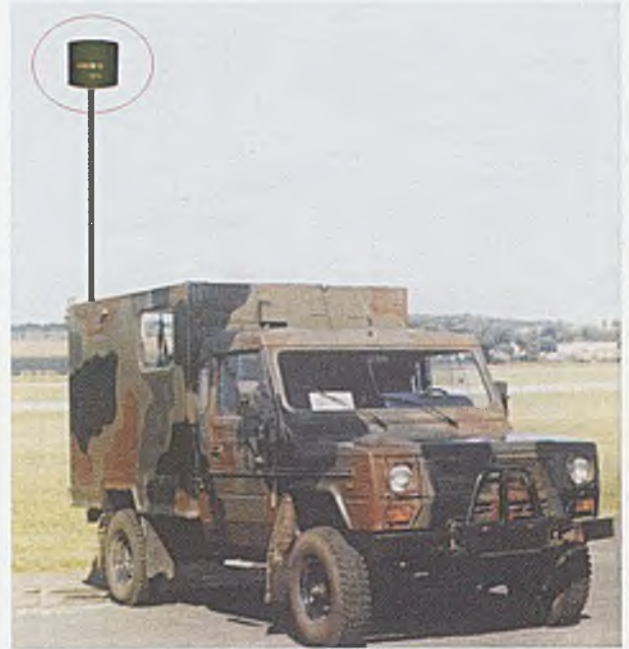
Rys. 6.8. LEMUR-10 zainstalowany na pojeździe rozpoznania elektronicznego
