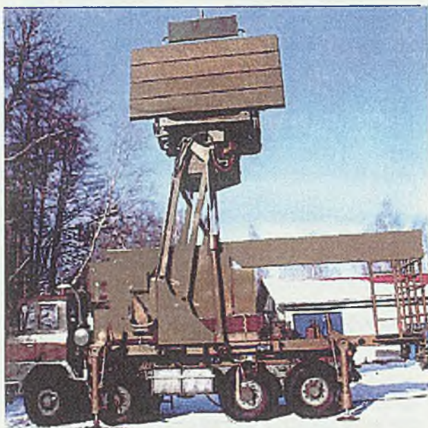
Rys. 3.27. Trójwspółrzędny radar średniego zasięgu na pasmo S
