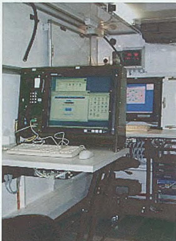
Rys. 10.17. Widok na zautomatyzowane stanowiska pracy w wozie ZWS-10S. Ekran płaski, o przekątnej ekranu 20 cali, rozdzielczość 1268 x 1024 pikseli
