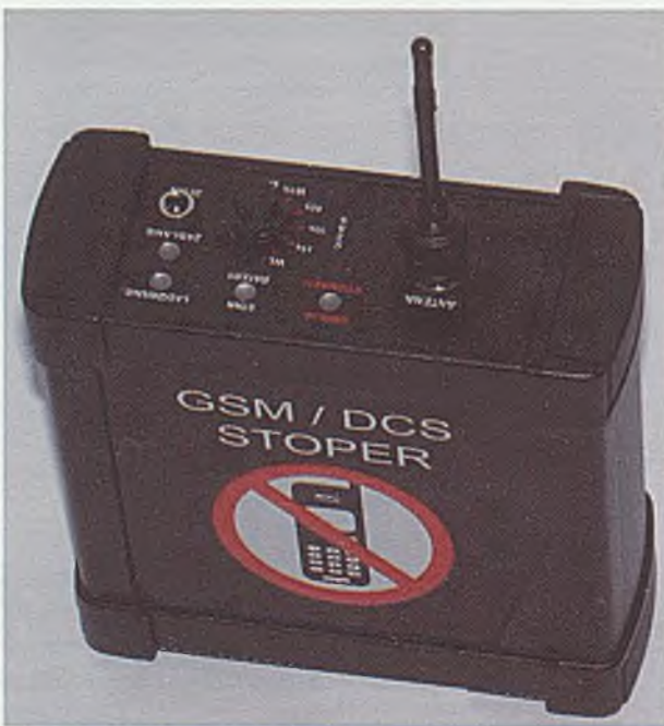
Rys. 8.25. Widok urządzenia do zakłócania odbiorników telefonów komórkowych
