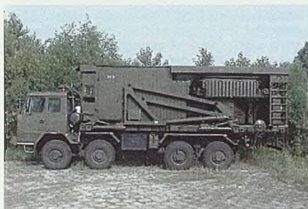
Rys. 3.28. Trójwspółrzędny radar średniego zasięgu w pozycji transportowej
