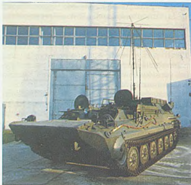
Rys. 10.12. Zautomatyzowany wóz dowodzenia ŁOWCZA 3 przygotowany do pracy na postoju – rozwinięty maszt z anteną dookólną, ADS –1 na zakres 30 –80 MHz
