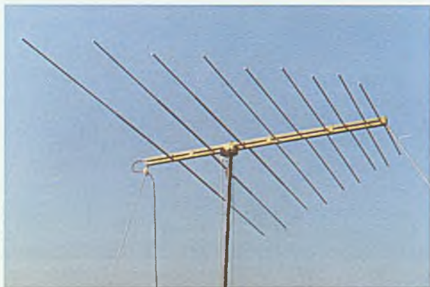
Rys. 10.10. Szerokopasmowa antena typu LPD na zakres 30 –80 MHz
