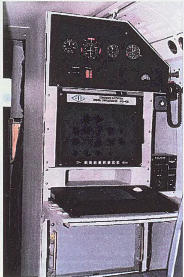
Rys. 4.12. Stanowisko operatora radaru ARS-400
