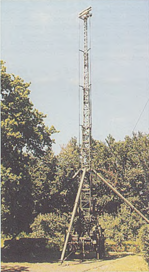
Rys. 4.3. Blok nadawczo- odbiorczy na rozwiniętym maszcie Ftm 24/4
