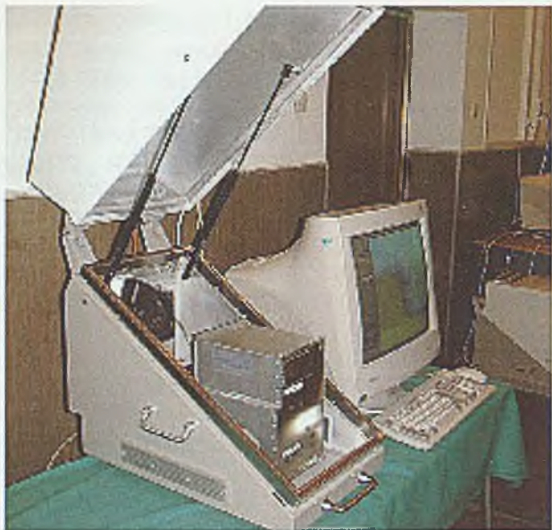
Rys. 10.26. Komputer w obudowie „Tempest”
