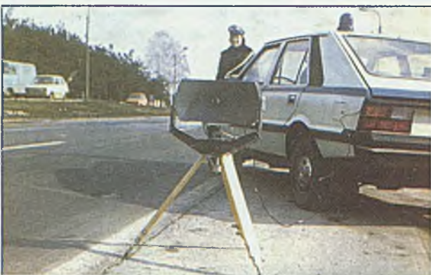
Rys. 8.18. Radarowy miernik prędkości typu SRD w warunkach eksploatacyjnych
