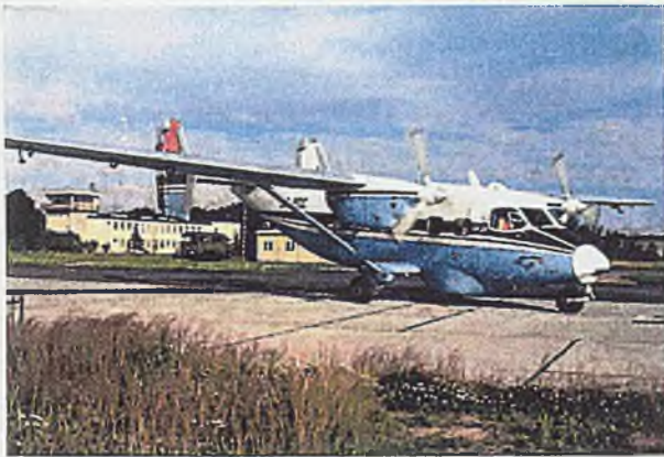
Rys. 4.8. Widok samolotu z radarem umieszczonym w dolnej części kadłuba
