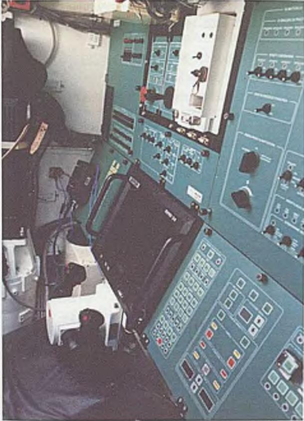
Rys. 7.7. Stanowisko operatora w wieży PZA LOARA
