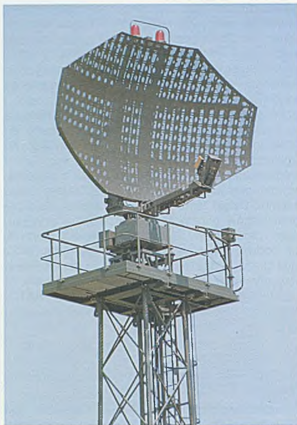
Rys. 3.22. Antena z blokiem napędowym na wieży zestawu WETLINA
