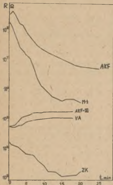
Rys. 7. Zależność rezystancji zastępczej tworzywa " R_{TW} " od czasu trwania tarcia ( V=0,52 m/s p = 0,30 \frac{MN}{m^2} )
