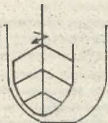
Rys. 5a. Schemat mieszadła planetarnego wykonującego dwa rodzaje ruchu obrotowego dookoła osi mieszalnika oraz dodatkowo dookoła osi własnej
