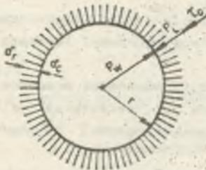
Rys. 2. Model pęcherzyka gazowego w ośrodku dyspersyjnym [4]
