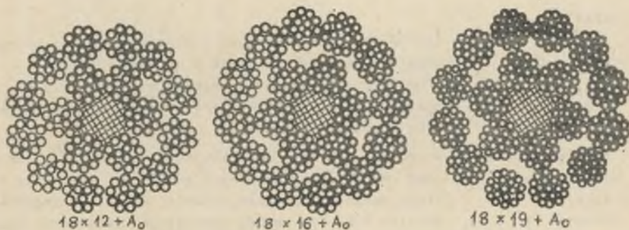
Rys. 1. Przekroje poprzeczne najczęściej stosowanych w kraju lin wyrównawczych okrągłych dwuwarstwowych typu GIG
