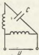
Rys. 1. Układ połączeń uzwojeń stojana typu L
