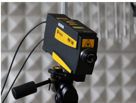
(d) The laser vibrometer Polytec PDV-100.
