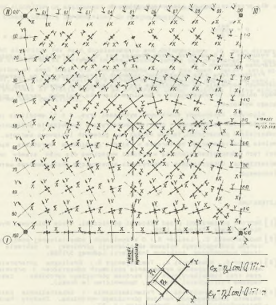
Rys. 5. Odształcenia główne nad narożem górniczego wyrobiska
