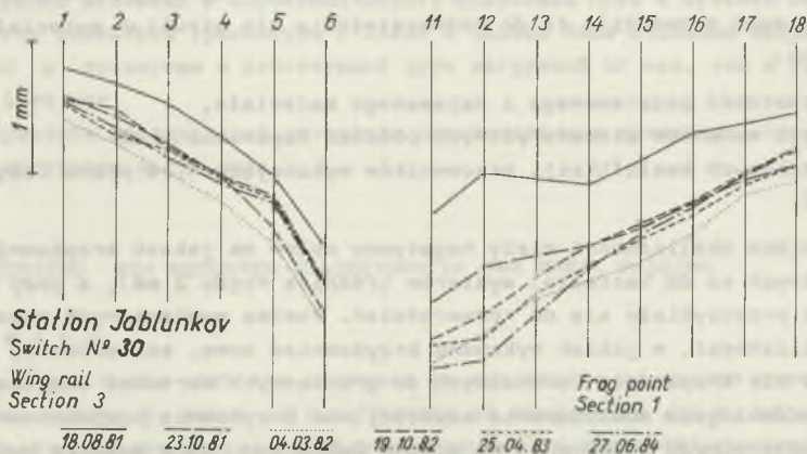
Rys. 1. Zapis graficzny zużycia krzyżownic eksperymentalnych
