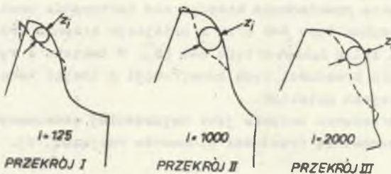
Rys. 2. Sposób pomiaru zużycia iglicy w przekroju poprzecznym
