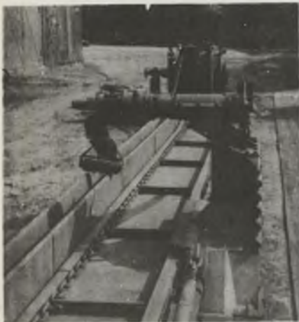
Rys. 1. Głowica strugowa ścianowego agregatu hydraulicznego GIG-AH1
