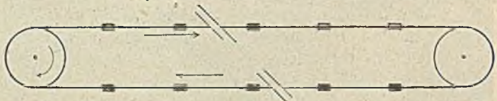
147. Принципъ устройства откатки безконечнымъ канатомъ.
