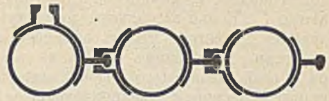
160. Сваи изъ желѣзныхъ трубъ системы Гаазе, для забивной шахтной крѣпи.
