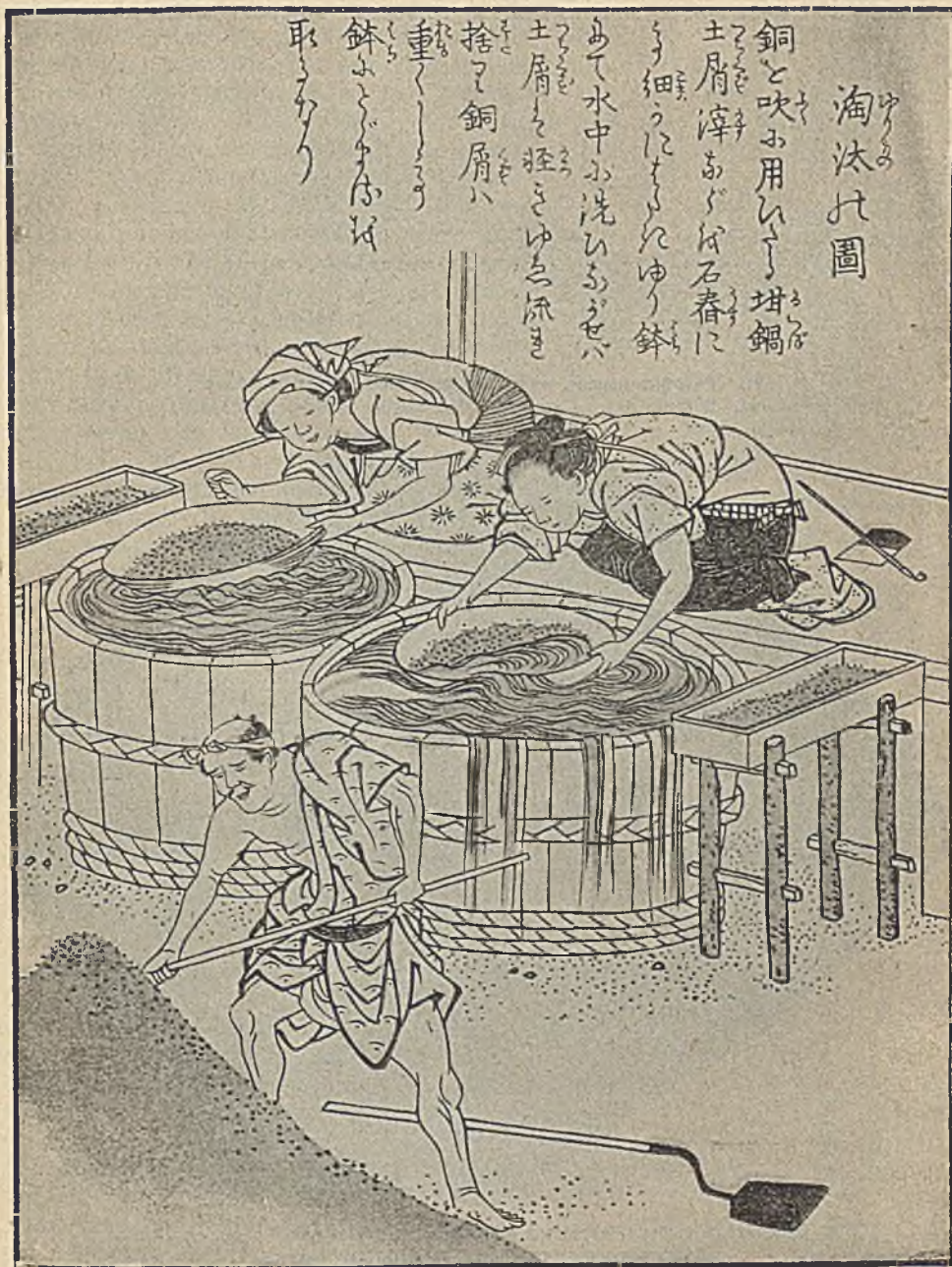
210. Промывка медной руды в чашах на рудникѣ Беши в Японіи. Рис. 209 и 210 заимствованы изъ стариннаго японскаго сочиненія.
