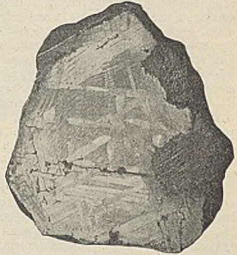
9. Метеорное желѣзо изъ Толука въ Мексикѣ, вытравленное сѣрной кислотой, для получения Видманштеттовыхъ фигуръ.
