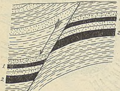
46. Поперечный разрѣзъ одного изъ сбросовъ въ отложенияхъ каменноугольной системы.
