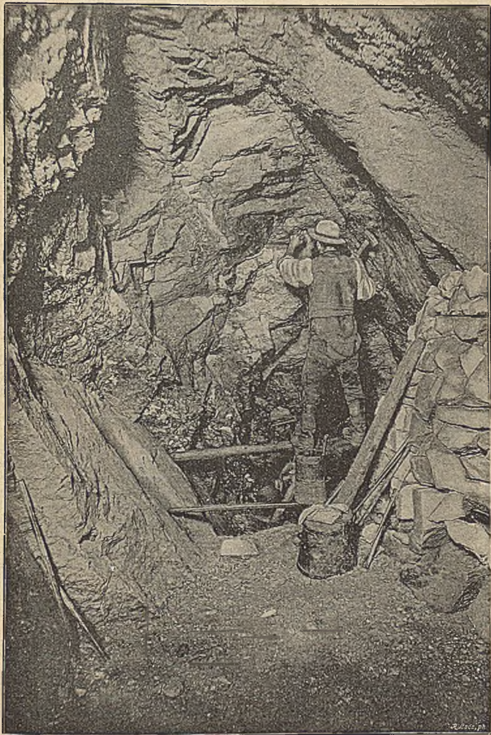
203. Забой при потолкоуступной работѣ на жилѣ Seligtrost Stehenden рудника Елизаветы въ Фрейбергѣ.
