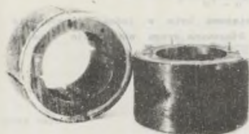
Rys. 7. Sekcje obudowy tubingowej przygotowane do badań
