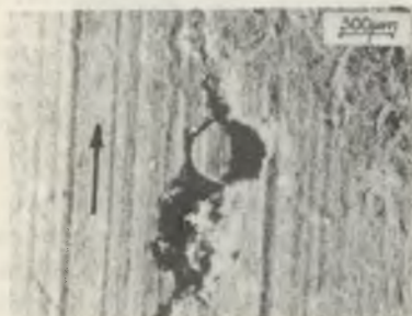
Rys. 31. Powierzchnia tarcia próbki tworzywa Galfel ( p_2 v_3 kw_1 ), wyciskanie narostku żelaza na zewnątrz nominalnej powierzchni tarcia
