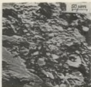
Rys. 28. Powierzchnia tarcia próbki tworzywa M-31 ( p_3 v_2 kw_1 ) ze skupiskami żelaza. MAR, 25 keV
