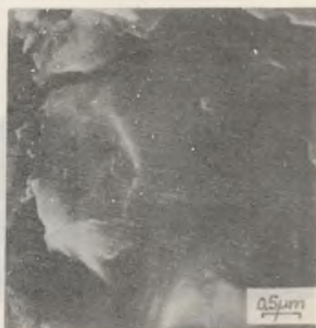
Rys. 24. Powierzchnia przeciwpróbki stalowej. Widoczne szczeliny i wykruszenia. SEM
