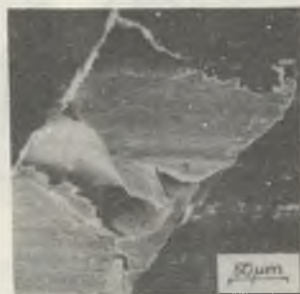
Rys. 38. Powierzchnia tarcia próbki tworzywa Polofen FA-3 ( p_2 v_3 kw_2 ). SEM. Widoczny duży wiór metalowy (CuZn) zniszczony w wyniku tarcia (jest on wyrwany z tworzywa)
