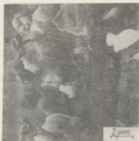
Rys. 24. Powierzchnia przeciwpróbki stalowej. Widoczne szczeliny i wykruszenia. SEM
