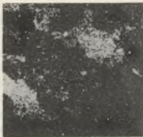
Rys. 28. Powierzchnia tarcia próbki tworzywa M-31 ( p_3 v_2 kw_1 ) ze skupiskami żelaza. MAR, 25 keV
