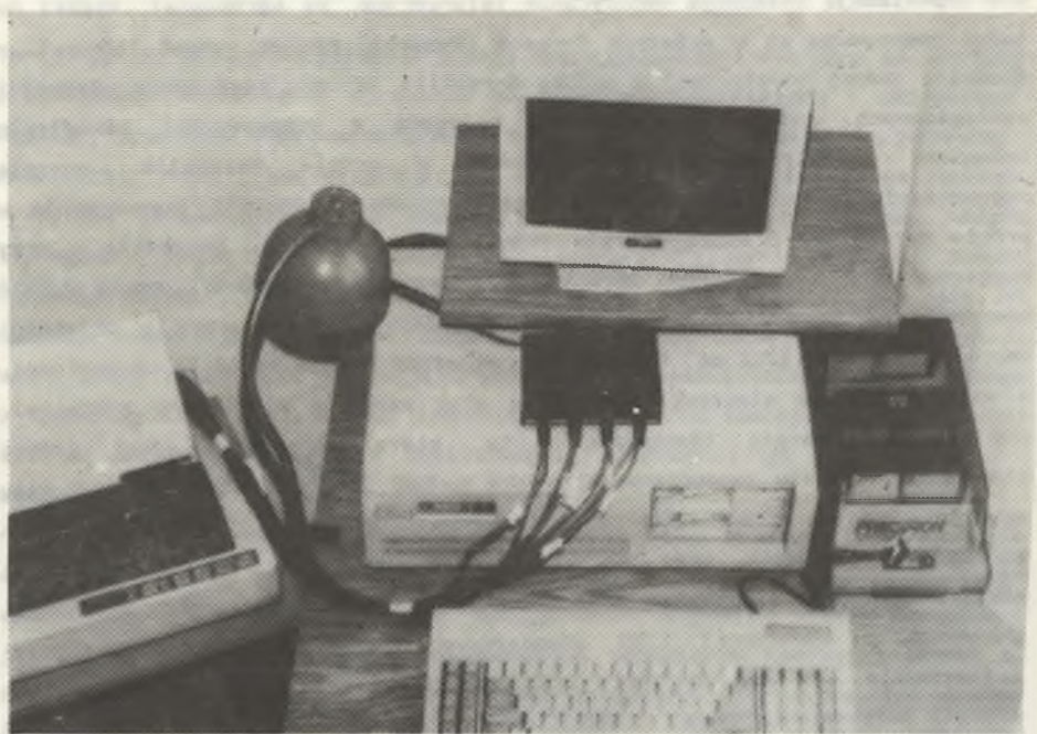
Rys. 8. Stanowisko komputerowe z interfejsem do połączenia wzmacniacza przemieszczeń liniowych
