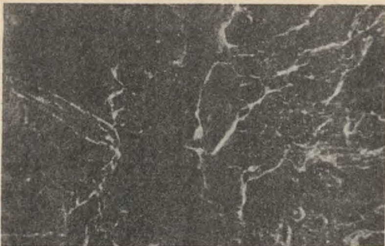
Rys. 44. Widok powierzchni złomu próbki zginanej nr 3, warstwa wykonana elektrodą EB 1.60. a = 9,6 mm, 2\sigma_a = 140 MPa, R = 0,3 . Widoczne na powierzchni zanikające prążki zmęczeniowe oraz pęknięcia odzłomowe. Średnia prędkość propagacji pęknięcia odtworzona na podstawie pomiaru odległości między prążkami da/dN = 1,25 \cdot 10^{-7} m/cykl, pow. 4000x
