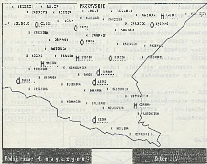
Rys.3. Przykład dwupoziomowego zadania lokalizacji dla rejonu przemyskiego, gdzie: o - odbiorca, d - dostawca, m - magazyn pośredni.
