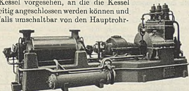
Abb. 212. Speisewasserpumpe mit Dampfturbinenantrieb und Getriebe.
