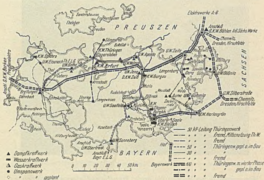
Abb. 380. Pumpspeicherwerk der Bleiloch-Saaleletalsperre und Netzplan für die Eingliederung in die Landesversorgungen von Thüringen, Preußen und Sachsen.
