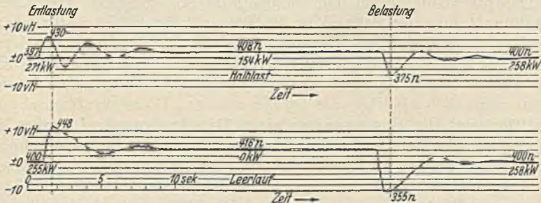
Abb. 283. Drehzahl-Regelverlauf bei Belastungsänderungen eines Krupp-Sechszylinder-Dieselmotors. 450 kW, n = 400 U/min.
