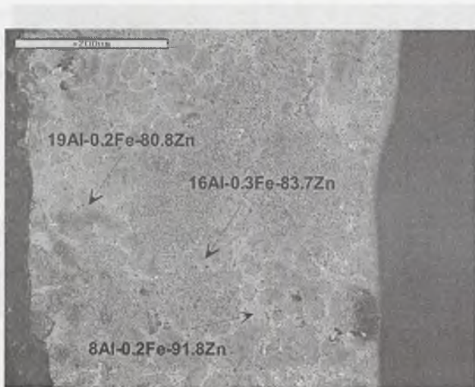
Rys. 112. Fotografia strefy dyfuzyjnej w zanurzonej próbce Al w ciekłym stopie układu Zn-Fe (próbka 4 – tabela 19)
