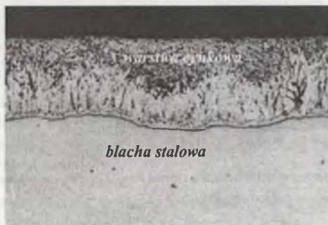
Rys. 154. Prawidłowa naniesiona warstwa cynkowa
