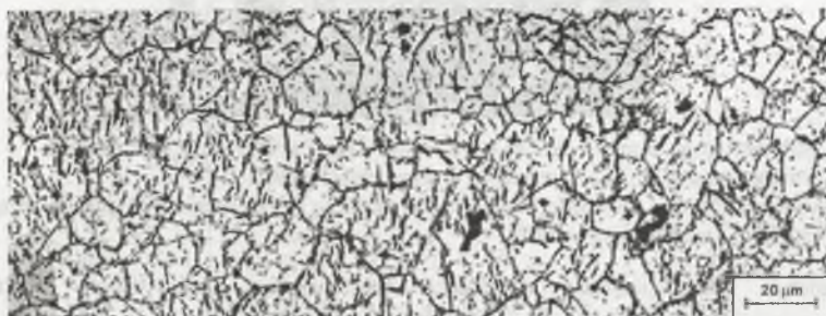
Rys. 5.12. Mikrostruktura stopu Fe-0,5Mo po przesycańiu azotem i starzeniu w temperaturze 350 0 C; widoczne wydzielenia azotku żelaza Fe 4 N w osnowie ferrytycznej Fig. 5.12. Microstructure of Fe-0,5Mo alloy after quench-aging at 350 0 C; precipitates of Fe 4 N nitride
