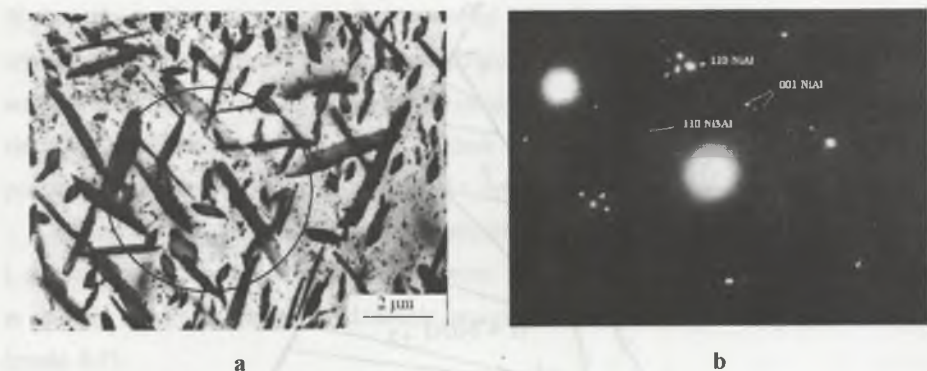
Rys. 8.8. Mikrostruktura stopu CuNi9Fe6Al5 (a) chłodzonego z piecem z temperatury 900 °C wraz z dyfraktogramem elektronowym (b) z oznaczonego obszaru obejmującego wydzielenia i osnowę [W9,W36]
