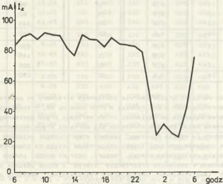
Rys. 3. Dobowy przebieg zmian wartości prądu doziemnego I_z w sieci S1 kopalni K9
