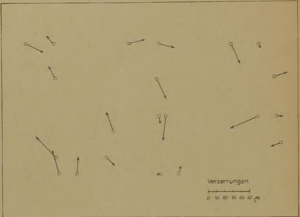
Abb. 5. Schichtverzerrung durch chemische Verbesserung der Platte. Platte Nr. 120, Agfa Aerochrom, verstärkt mit Agfa-Kupfer-Verstärker. Die Kreise bezeichnen die Punktlage vor der Verstärkung.
