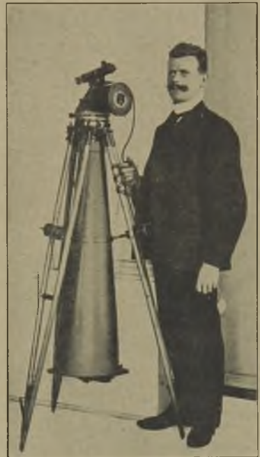
Abb. 4. Vertikal-Kamera 18×24 cm und f = 1,37 m mit Horizontalkreis und Zielfernrohr, konstruiert 1905.
