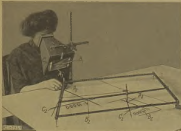
Abb. 8. Einfacher Umzeichner mit Pantograph. (Entnommen der Zeitschr. d. Ver. Deutscher Ingenieure v. 29. 12. 1928 S. 1908.)
