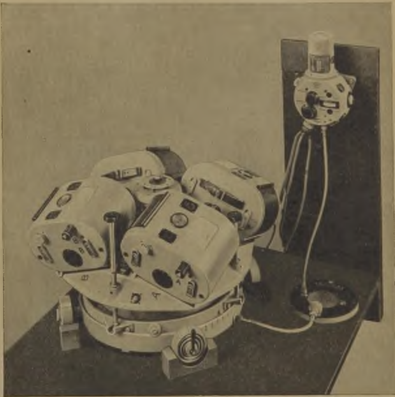
Abb. 1 Vierfach-Reihenbildmeßkammer „Hydra“. 4 \times 460 Einzelaufnahmen.
