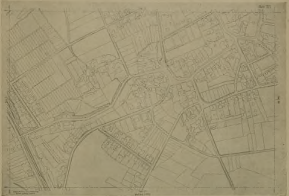
Abb. 3. Verkleinerung eines Blattes 1:1000. Rohplan, ausgemessen aus Luftaufnahmen.
