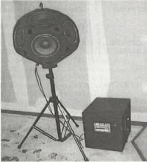
Rys. 6. Zestaw do generacji akustycznych sygnałów testowych wraz z kulą głośnikową.
