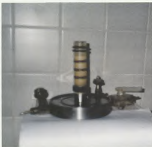
Rys.19. Zdjęcie próbki zagęszczonej w osłonce gumowej po rozformowaniu cylindra dwudzielnego
