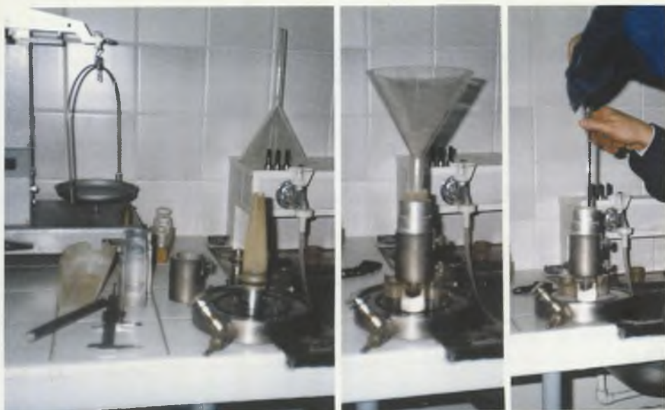
Rys.18. Zdjęcie sposobu zagęszczania próbki w cylindrze dwudzielnym mocowanym na podstawie komory aparatu trójosiowego
