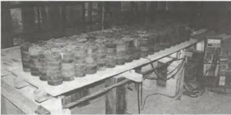
Rys. 3. Model stropu pod obciążeniem równomiernie rozłożonym 16 \text{ kN/m}^2 Fig. 3. Model of slab subjected to the uniformly distributed load of 16 \text{ kN/m}^2
