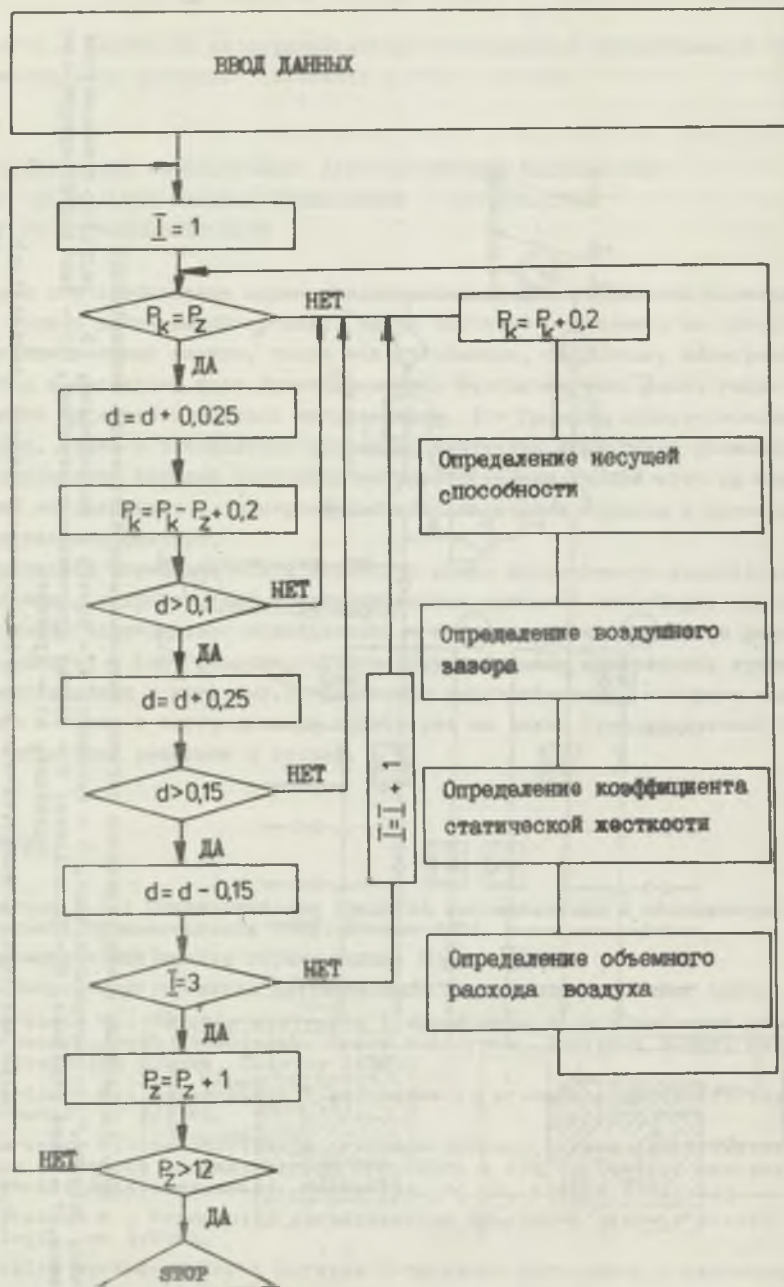
Рис. 2. Блок-схема общего расчетного алгоритма аэростатических направляющих Rys. 2. Schemat blokowy ogólnego algorytmu obliczeniowego prowadnic aéro- statycznych
