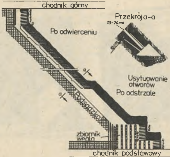
Rys. 14. Ściana bez obudowy rozwiązanie stosowane w kop. Auguste Victoria Fig. 14. Longwall without a support, solution applied in Auguste Victoria coal mine
