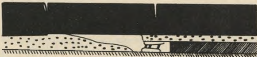
Rys. 2. Pęknięcie i łamanie się sztywnego stropu Fig. 2. Cracking and breaking of rigid roof
