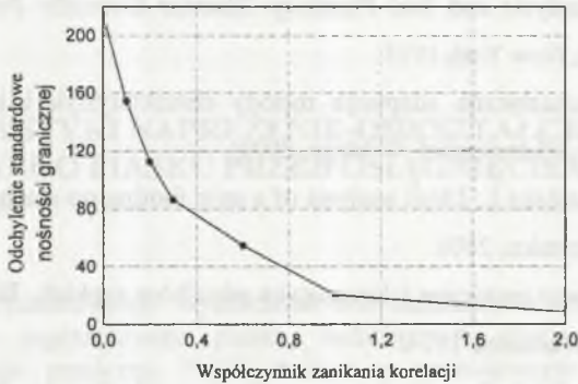
Rys. 5. Odchylenie standardowe nośności granicznej a współczynnik zanikania korelacji \lambda
