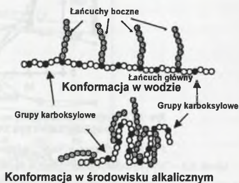
Rys. 3.29. Konformacja polimeru PC z łańcuchami bocznymi w środowisku wodnym i w środowisku alkalicznym o dużej koncentracji jonów \text{SO}_4^{2-} [169]
