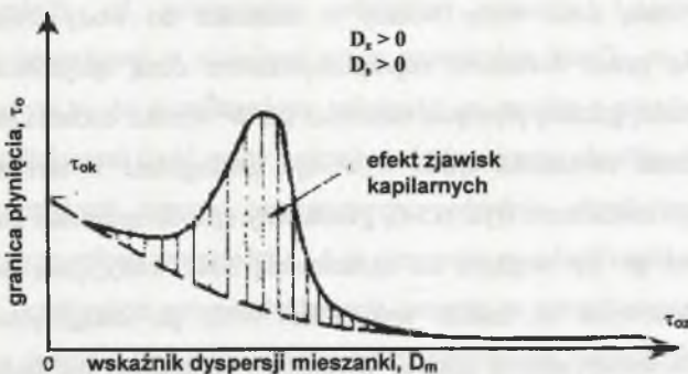
Rys. 6.54. Wpływ zjawisk kapilarnych na wielkość granicy płynięcia mieszanki betonowej wg [154] Fig. 6.54. Effect of capillary phenomenon's on yield stress of fresh concrete according [154]
