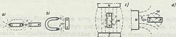
Rys. 1. Oddziaływanie siłowe pola magnetycznego na przedmiot ferromagnetyczny
