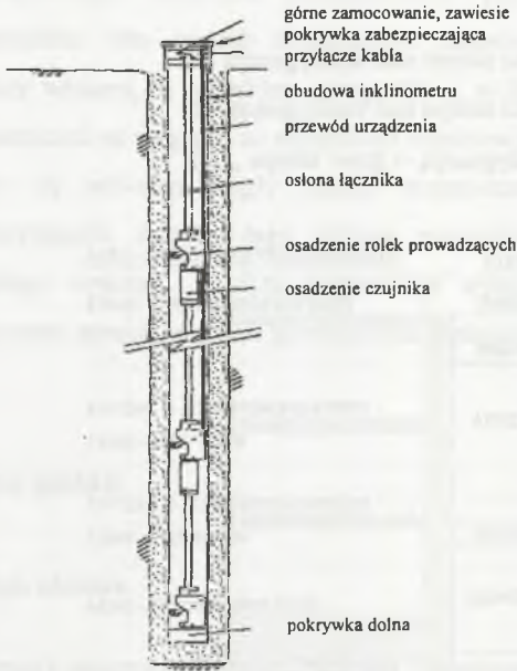
Rys. 2. Schemat budowy pionu pomiarowego Fig. 2. The principle of inclinometer chain composition
