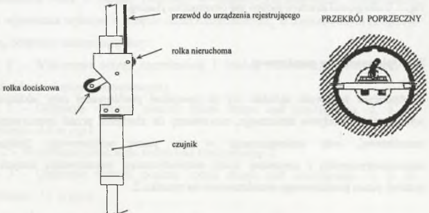
Rys. 3. Schemat instalacji inclinometru Fig. 3. The principle of inclinometer installation
