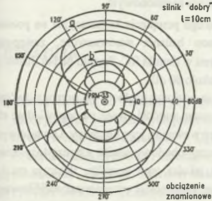
Rys.10. Wpływ obwodu tłumiącego na poziom zakłóceń; a) tłumik warystorowy, b) tłumik RC
