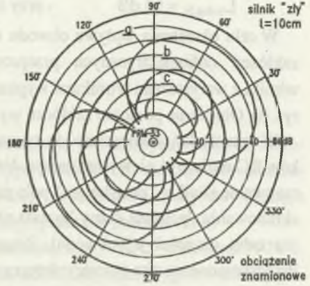
Rys.11. Wpływ kontaktu elektrycznego między obudową, a tarczą łożyskową na poziom zakłóceń; a) wykonanie fabryczne, b) po oczyszczeniu styku obudowa-tarcza, c) po zmniejszeniu luzu między obudową i tarczą łożyskową
