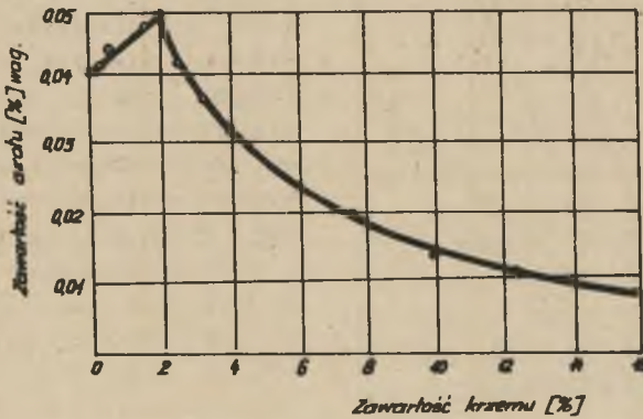
Rys. 7. Wpływ krzemu na rozpuszczalność azotu w ciekłym żelwie przy 1630°C [19]
